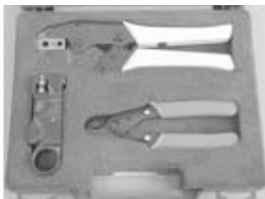
НТ-3014К Набор для монтажа на кабель RJ58, RJ59, RJ62 из 3-х предметов (НТ-3014К): 1) Кусачки НТ-206 2) Устройство для зачистки кабеля НТ-312А 3) Обжимные клещи НТ-310-С
